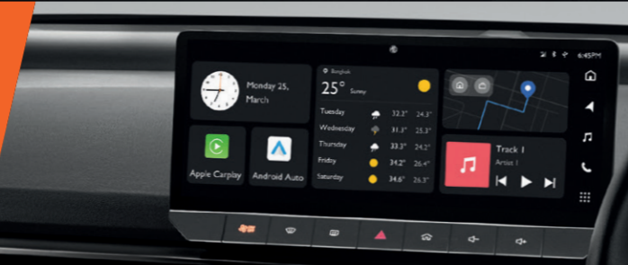
หน้าจอ TOUCHSCREEN ขนาดใหญ่ 12 นิ้ว (เฉพาะในรุ่น STANDARD RANGE และ LONG RANGE)
